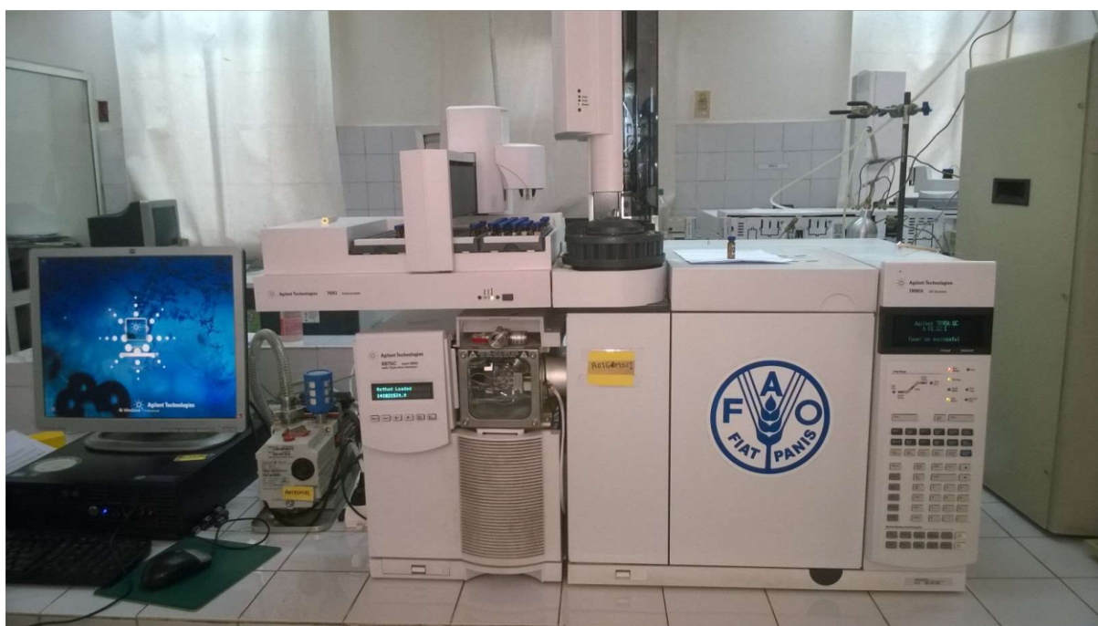
Figure n° 12. Chromatographe en Phase Gazeuse Agilent® couplé à un détecteur de masse (GC-MS) pour l'analyse des résidus de pesticides, de PCB et d'autres polluants chimiques
