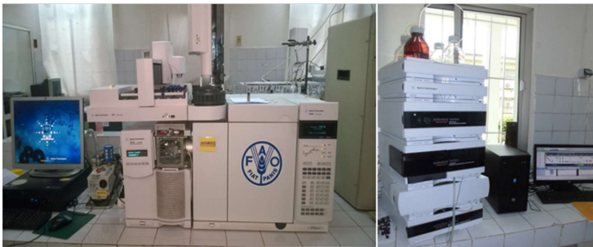
Figure n° 11. GC-MS et HPLC Agilent pour l'analyse des pesticides
