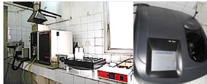
Spectrophotomètre d'Absorption Atomique (SAA) et ses accessoires (Digesteur, flamme, hydrure et four), pour l'analyse des traces de métaux lourds et de la qualité des engrais chimiques
